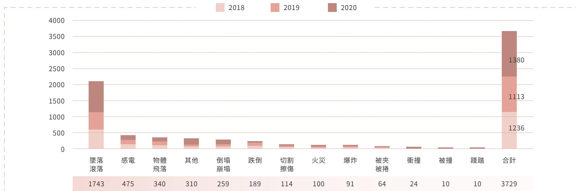
經上開簡述之「安全流程」及「安全施工」落實執行及檢討：分析連續統計三年(2018~2020)之現場查核缺失危害類型，以墜落滾落為主要危害之首要，佔三年總查核缺失次數之46.7% (=1743/3729) 3729)，遠大於後二名之電12.7%及物體飛落( )。墜落之危害雖於2019年查獲缺失降低，但至2020年則查得缺失次數逾600次，較2018年高。故施工現場之職安管理應首重墜落預防，其預防措施依法可設置護欄、護蓋、安全網，而於不能設置前開設施時則予施工人員著用勤墜系統之個人防護具。
